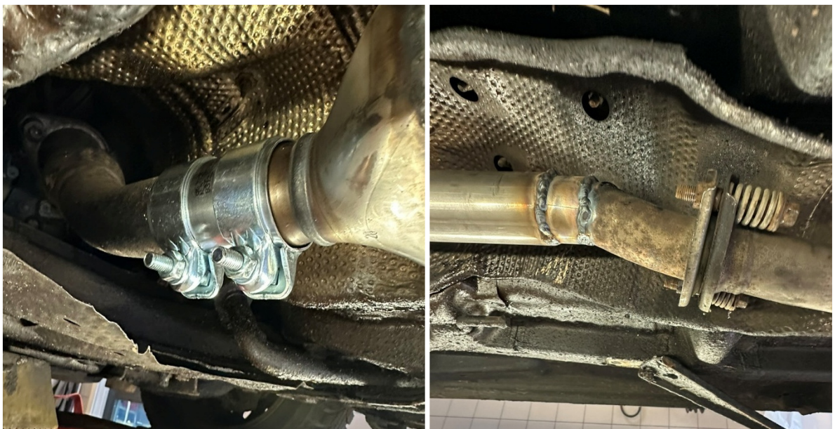
DPF monteret med rørsamler forrest, og svejse bagerst.
