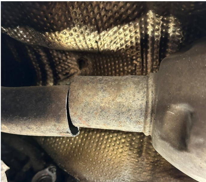
Den originale katalysator afmonteres ved at skære ca. 80mm før, og kort efter katalysatoren
