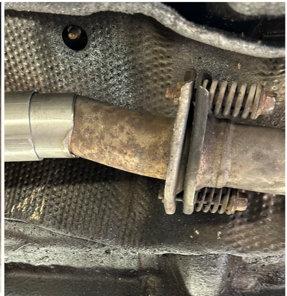
Den originale katalysator afmonteres ved at skære ca. 80mm før, og kort efter katalysatoren
