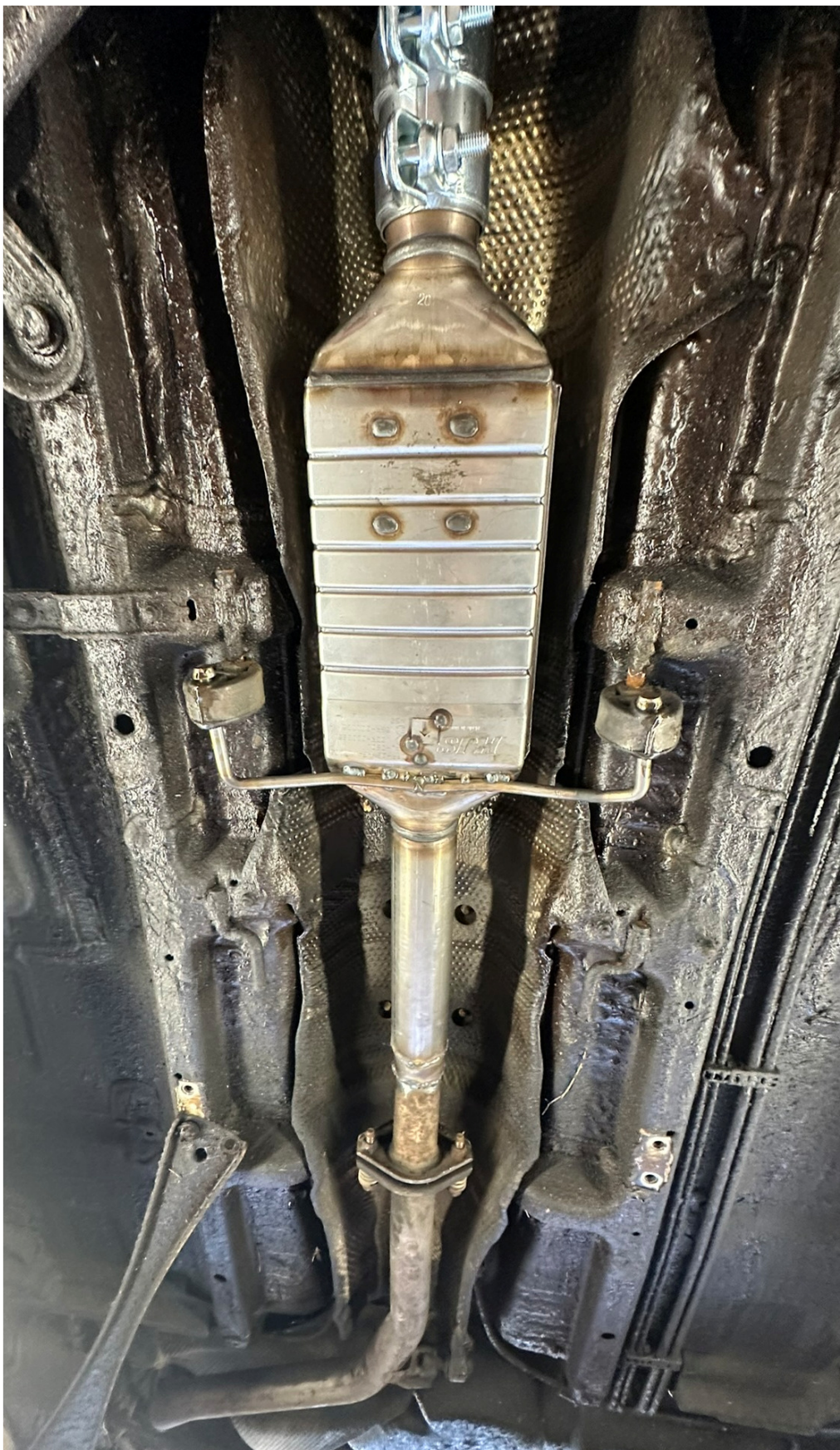
DPF monteret med rørsamler forrest, og svejse bagerst, og rundjern til gummiophæng bøjet og svejset på filter.
