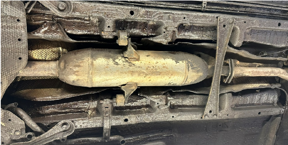
Originale katalysator afmonteres ved at skære ca. 80mm før, og kort efter katalysatoren
